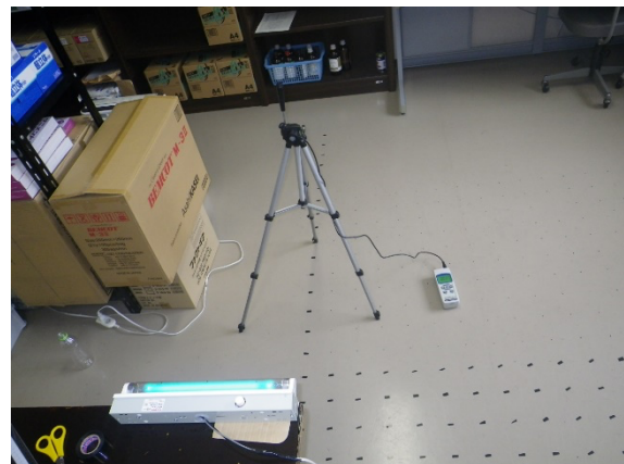
写真 1 室内での UVC 計測の様子
