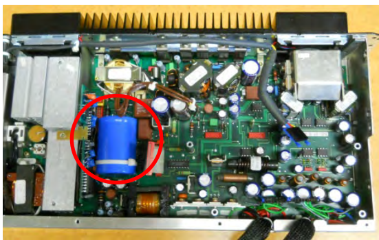
写真 2 アナライザ電源ユニット (修理前)
