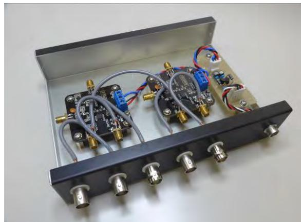
図4 完成した周波数変換器のケース内部
