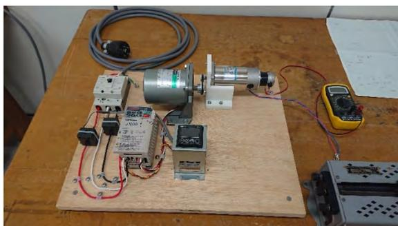
図 2 三相インバータ実験装置
