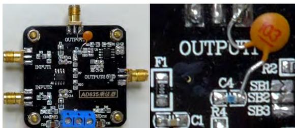
図2 海外製の実装済みボードと追加したLPF
