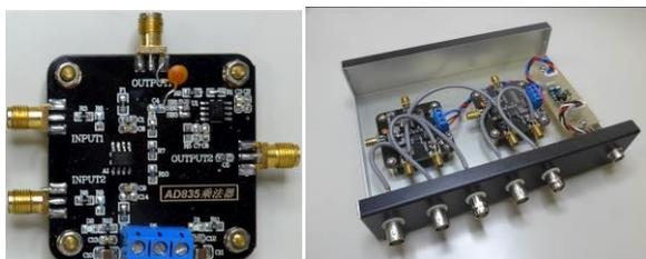
図5 前回使用したAD835実装済みの海外製ボード(左)と完成した装置(右)
