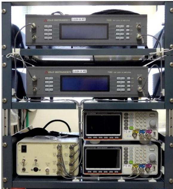
図8 標準ラックに組み込んだ本装置(左下)とロックインアンプ(上段)およびファンクションジェネレータ(右下)
